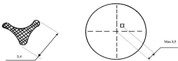
Рис.10. Поперечное сечение клинка шпаги и эксцентризитет гарды.
